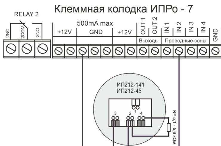
Подключение одного датчика
