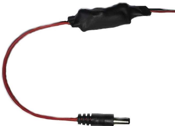
Преобразователь напряжения на базе микросхемы XL4005 предназначен для преобразования напряжения от 20 до 30 вольт постоянного тока в напряжение 12В постоянного тока. Преобразователь имеет встроенную защиту от перегрева ( $T > 125^{\circ}\text{C}$ ) и защиту по току от короткого замыкания на выходе устройства (8А).
