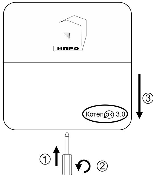
1. Откройте крышку прибора, для этого открутите винт с нижнего края крышки, как показано на рисунке ниже, и потяните крышку на себя.
