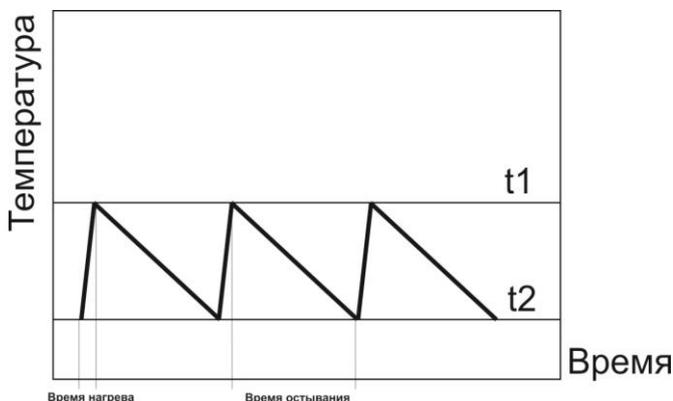
Данный параметр устанавливает разницу между температурой включения и выключения отопительного оборудования. Диапазон регулировки от 0,1 до 2 градусов. По умолчанию установлено значение 0,5 градуса.
