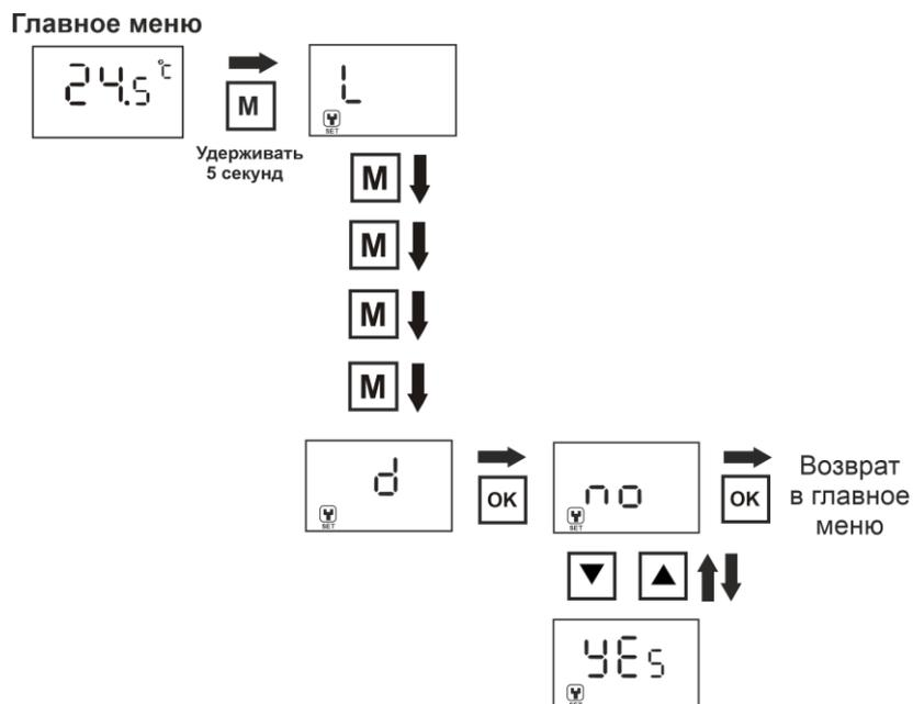
После выбора «Yes» раздастся звуковой сигнал и параметры термодатчика будут сброшены на заводские
