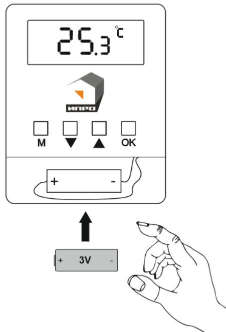
Установите батарейку в батарейный отсек и закройте крышку.
