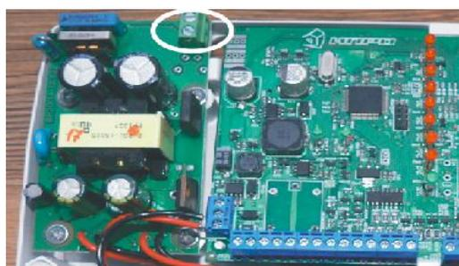
Подключаем сетевую вилку к клеммам блока питания (показано на рисунке). Для удобства подключения рекомендуется снять основную плату прибора, а затем установить ее на место. Включаем прибор в розетку, дожидаемся полной загрузки прибора (светодиод «GSM» должен мигать)
