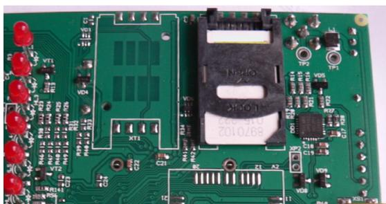
Устанавливаем SIM-карту в крышку слота и закрываем его в обратном порядке открытию.
