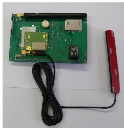
Подключаем к прибору GSM и RF антенны (вкручиваем) согласно рисунку
