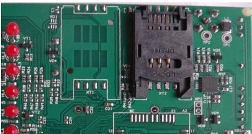
Прибор «Часовой 8x8-RF-BOX» имеет один слота для установки SIM-карты. Для настройки и работы прибора необходимо наличие SIM-карты в слоте.
