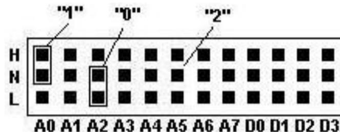
12 рядов перемычек разделены на 2 сектора A0...A7 и D0...D3. Для программирования датчика необходимо выставить перемычки в зоне "А" в соответствии с кодом запрограммированным в контрольной панели. В зоне "D" перемычки выставляются в соответствии с номером необходимой зоны.
